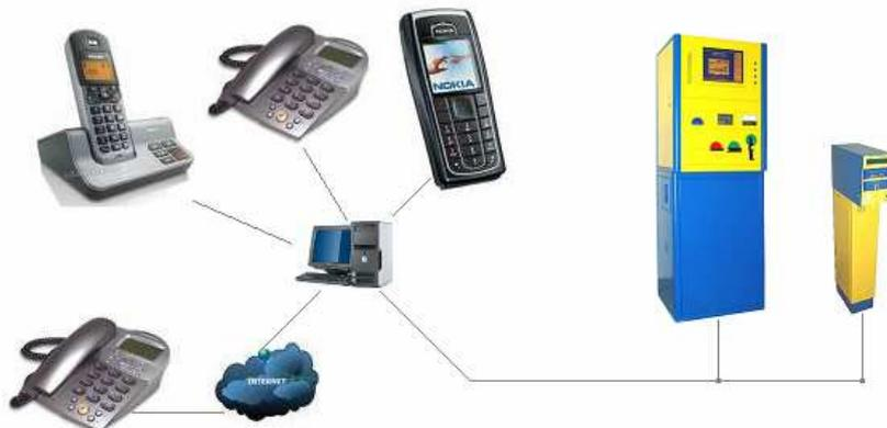
• La struttura Voip permette il trasferimento delle chiamate verso dispositivi interfonici fissi, verso terminali portatili locali tipo Dect, verso terminali portatili Gsm ed anche verso terminali remoti attraverso la rete Internet.
